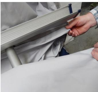
**9** Die geöffnete Vorderfront der Hülle mit dem kurzen Klettband vorübergehend vorne an die Klettschlaufen anklappen, damit die Front nicht auf den Boden herunterhängt und verschmutzt.
