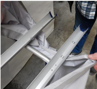
**8** Im Anschluss den geöffneten Klettverschluss um die Kufen und Holme herum schließen.
